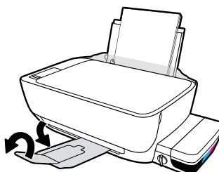
Inserte la pila de papel blanco normal y después ajuste la guía. Tire de la bandeja de salida y del extensor.
