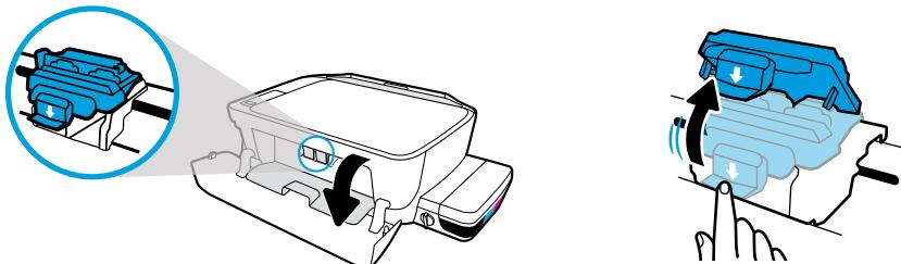
Abra la puerta delantera y la puerta de acceso al cabezal de impresión. Presione para abrir el pestillo azul del carro.
