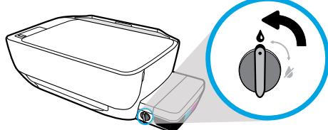
Debe desbloquear la válvula (posición vertical) antes de imprimir para que la tinta pueda fluir.
