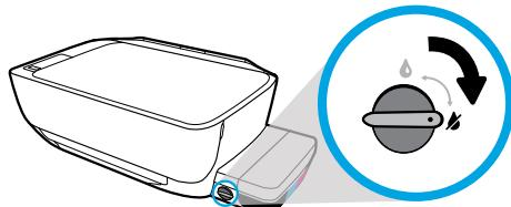
Debe bloquear la válvula (posición horizontal) antes de mover o inclinar la impresora para que la tinta no gotee.
