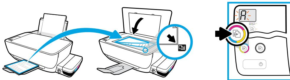
Coloque la página de alineación sobre el cristal del escáner. Pulse para escanear y alinear la impresora.
