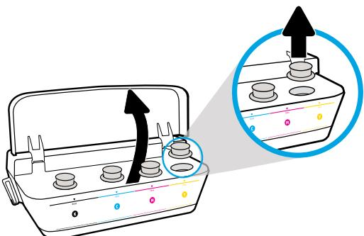
Abra la tapa del depósito de tinta. Retire el tapón del depósito amarillo.
