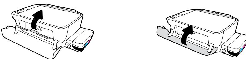
Cierre la puerta de acceso al cabezal de impresión y después cierre la puerta delantera.
