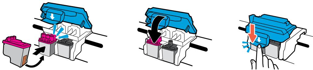
Deslice los cabezales de impresión hasta que queden bien colocados. Cierre fuertemente el pestillo azul del carro.
