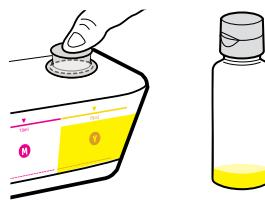
Sostenga la botella amarilla en la boquilla del depósito y eche tinta. Vuelva a poner el tapón el tapón y presione firmemente para cerrar.
