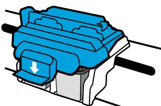
**IMPORTANTE:** mantenga cerrado el pestillo azul del carro después de la instalación del cabezal de impresión.
