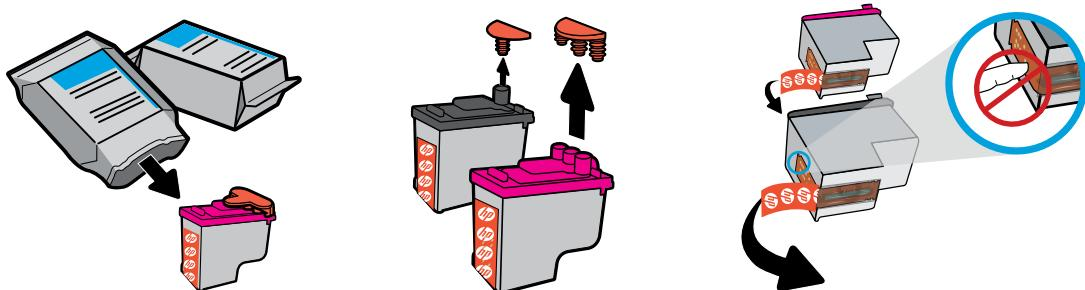
Retire los tapones de la parte superior de los cabezales de impresión y después retire la cinta de los contactos con las lengüetas.
