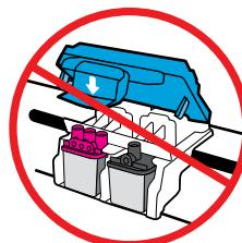
Tras la preparación de los cabezales de impresión con tinta, no debe abrir el pestillo azul del carro. La apertura del pestillo puede causar daños a los cabezales de impresión.
